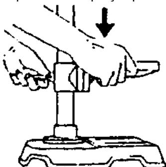
Регулировка угла наклона вертикального стола
