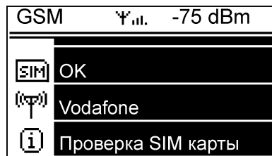
Рис. 5.7 Пример индикации состояния GSM модема на главной странице
