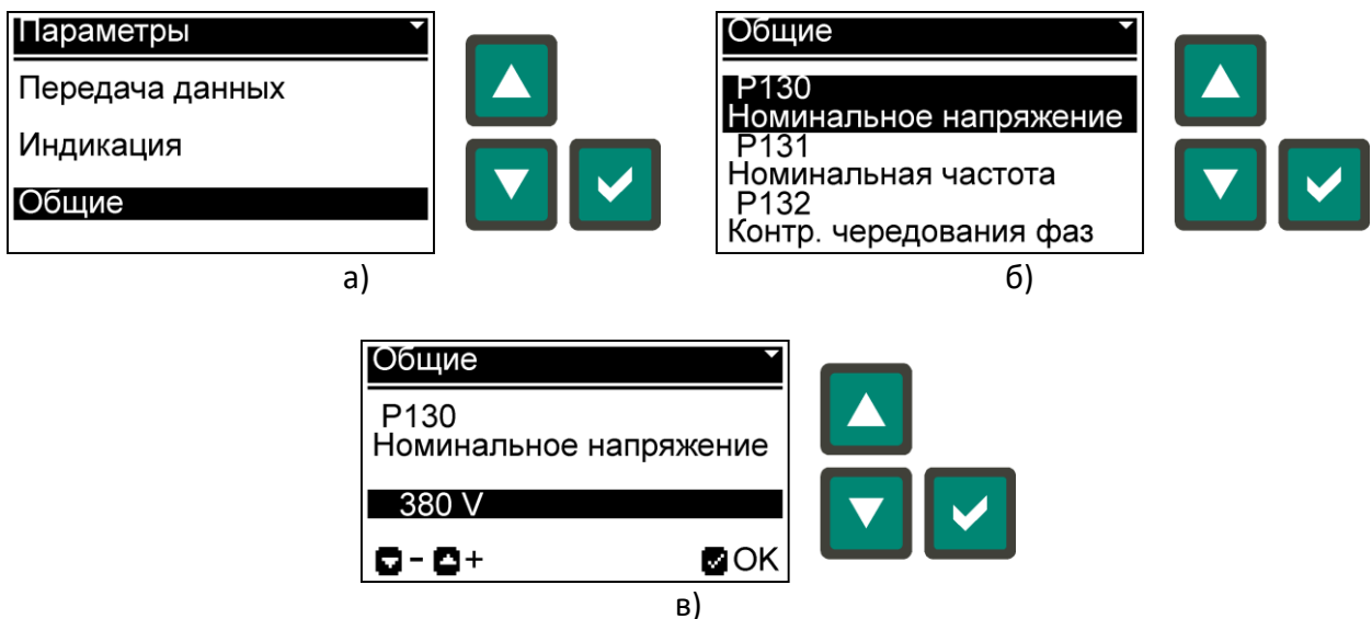
Рис. 5.11. Пример изменения параметра P130 - «Номинальное напряжение»: а) выбор группы параметров; б) выбор параметра; в) изменение параметра.
