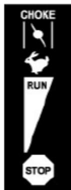
**УПРАВЛЕНИЕ ДРОССЕЛИРОВАНИЕМ НА ДВИГАТЕЛЕ HONDA**
