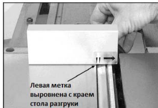
Рис. 23 (строгальный вал с прямым расположением ножей)
