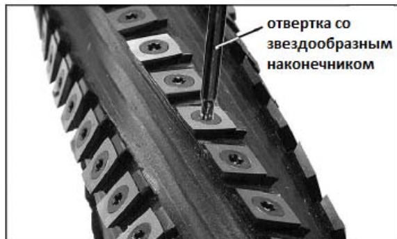
Рис. 30 (для строгального вала Helical)
