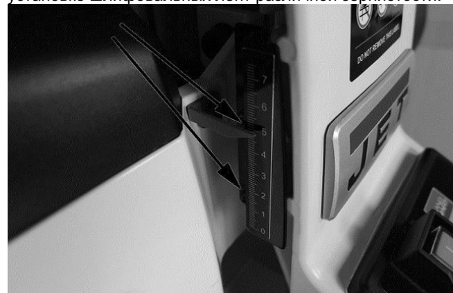
Рис. 8-1: настройка шкалы глубины
