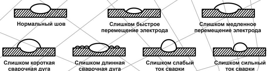
Рисунок 6. Основные виды ошибок при сварке полуавтоматом.
