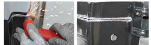
СТАЛЬ : макс 6 мм ALU : макс 4 мм (Скорость = 20 см/мин при 20А)
