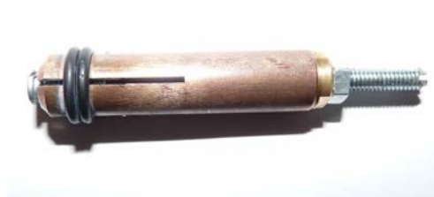
Медный наконечник с 4 прорезами для приваривания шпилек М4 (диаметр Ø 4 мм)
