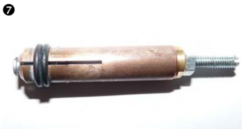
Boquilla en cobre a 4 grietas para soldar las clavijas M4 (diámetro Ø 4 mm)
