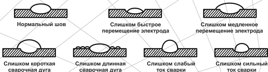
Рисунок 6. Основные виды ошибок при сварке полуавтоматом.
