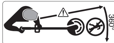
Prendre les précautions nécessaires pour que les personnes se trouvant à proximité ne risquent pas d'être blessées par des projections provenant de l'outil.
