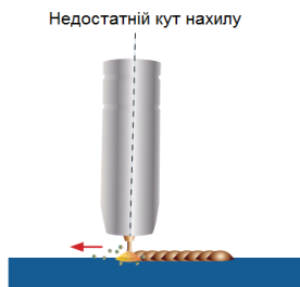
Збільшене розбризування металу, погіршений контроль зварювання
