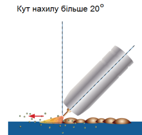
Велике розбризування, поганий контроль зварювання та погане проплавлення, нестабільна дуга
