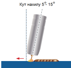
Відмінне формування шва, гарний контроль зварювання
